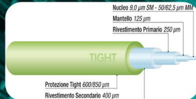
**Protezione aderente (Tight)** consiste nell'applicazione di un doppio strato aderente alla fibra, generalmente composto da un primo rivestimento in resina siliconica reticolata ai raggi UV, con la funzione di protezione morbida, oltre a un secondo strato esterno di poliammide o materiali simili, meccanicamente molto più resistenti. Questa soluzione è realizzata principalmente per fibre utilizzate per bretelle o per cavi multipli di monofibra.
