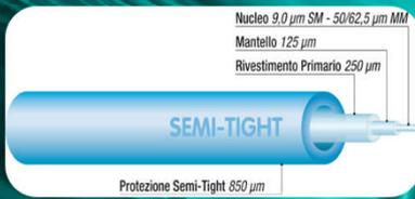
**La protezione semi-aderente (Semi-Tight)** consiste in un sottile rivestimento termoplastico applicato non aderente su una o più fibre. Comunemente il materiale impiegato è antinfiamma a basso sviluppo di fumi e zero alogeni (LSZH). Questa soluzione è impiegata per cavi flessibili o di piccole dimensioni, come i cavi FTTH, quando per esempio è necessario strappare le fibre per lunghi tratti.
