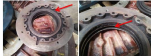
Fig.6-7 flangia bloccaggio DE con zona di passaggio grasso e dettaglio mancanza feltrini
