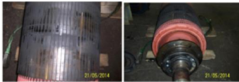
Fig. 1-2 rotore e cuscinetto DE
