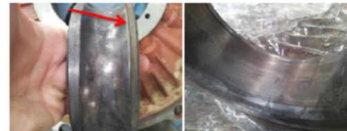
Fig.4-5 Anello interno cuscinetto DE - surriscaldamento, rifollamento(indicato da freccia) e rotazione sull'albero
