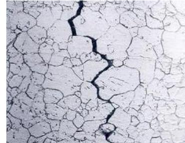
*SCC con corrosione che segue il bordo del grano*
