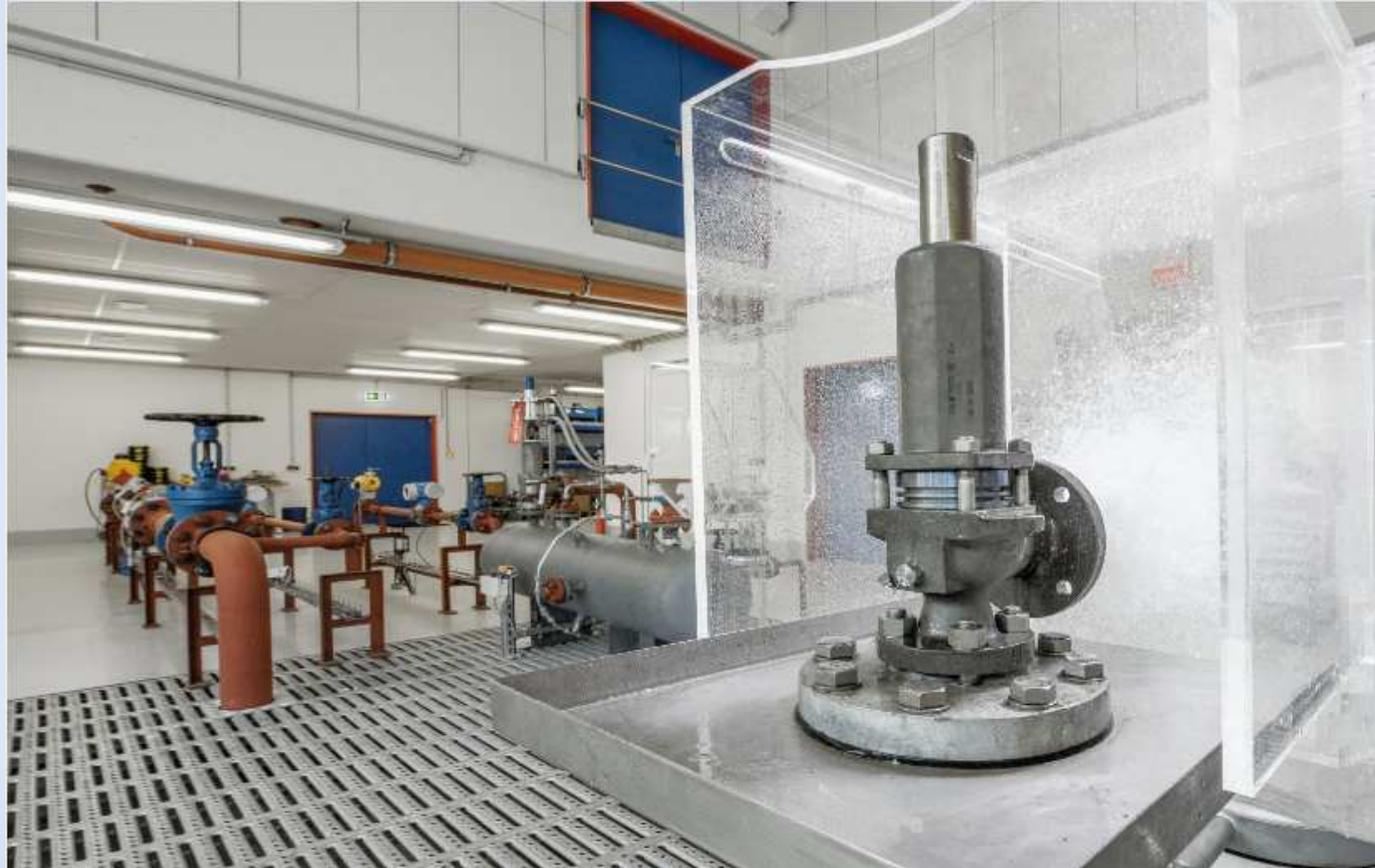
Il coefficiente di scarico viene stabilito tramite apposite test in laboratorio.
