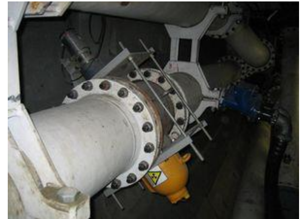
Misura di densità in pozzi di perforazione
