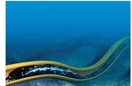
Slug liquido in movimento all'interno di una tubazione
