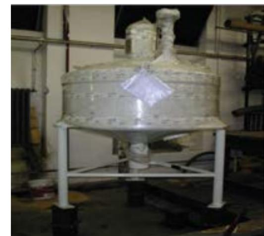
riferimento metrologico primario utilizzato per la taratura della vasca di raccolta è un serbatoio campione di volume pari a uno m³ (Figura 3). Una volta installato lo strumento sulla linea di taratura (Figura 4), che è alimentata da un serbatoio a carico mantenuto costante grazie a un sistema di lunghi stramazzi disposto lungo i bordi del serbatoio stesso, lo schema di funzionamento per la prova è il seguente (Figura 1).
