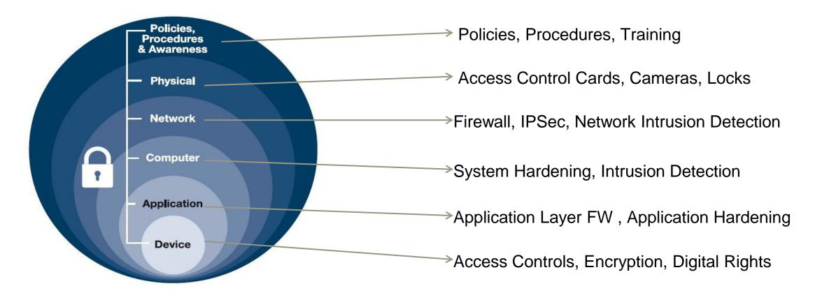
IEC 62443: standard security in ambito IACS – Industrial Automation and Control System - basato sul principo "Defense in depth" → protezione su più livelli
