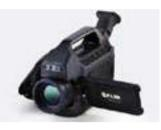
capace di rilevare rapidamente le emissioni fuggitive delle più piccole concentrazioni di metano, idrocarburi e composti organici volatili.
