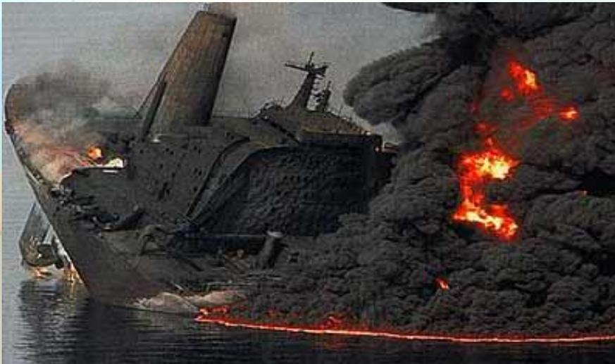
6 MIGLIA A LARGO DEL PORTO DI GENOVA, DURANTE IL TRAVASO DEL CARICO DA PRUA A CENTRO NAVE, FORSE PER IL MALFUNZIONAMENTO DI UNA POMPA, SI VERIFICÒ UN'ESPLOSIONE CHE FECE SALTARE CENTO METRI DI COPERTA NELLA PARTE PRODIERA. DURANTE L'INIZIO DELL'OPERAZIONE DI TRAINO, LA PARTE PRODIERA, INDEBOLITA DALLE ESPLOSIONI, SI STACCÒ DAL RESTO DELLO SCAFO
